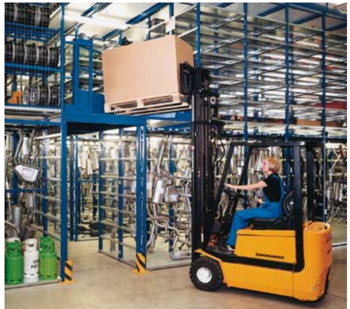
3-geschossige Fachbodenregalanlage mit Palettenübergabepplatz. Branche: Kfz-Teile-Handel
